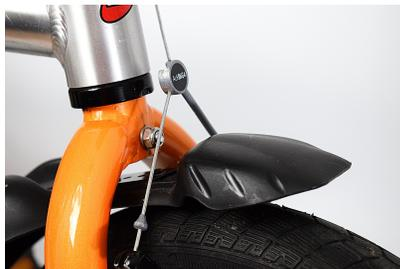
Die Montage erfolgt unten am Gabelrohr, an der dort bereits vorhandenen Bohrung. Bei vielen Kinderrädern ist hier bereits ein Schutzblech und/oder ein Reflektor montiert. Um nun das STREET-TAG montieren zu können, muss zuerst die bereits vorhandene Schraube demontiert werden. Ein eventuell vorhandener Reflektor wird nun nicht mehr benötigt, ein Schutzblech wird weiter verwendet.
