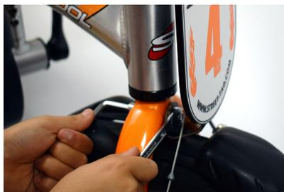
Die Montage ist etwas knifflig, da der Platz innerhalb des Halters recht eng ist. Während des Festziehens bitte die Position kontrollieren und ggf. korrigieren, damit das STREET-TAG front schön gerade sitzt.
