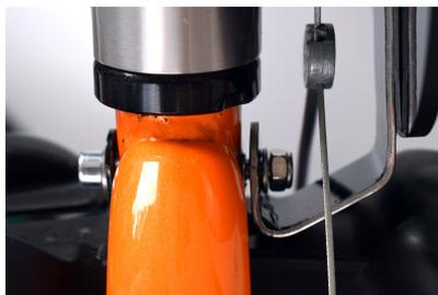
Zur Montage wird nun auf die mitgelieferte Schraube eine der beiden Unterlegscheiben gesteckt und anschließend die Schraube von hinten in die Bohrung des Gabelrohrs geführt. Anschließend wird auf die Schraube, die nun vorne aus dem Gabelrohr herauschaut der Federring, das STREET-TAG, die Unterlegscheibe und die Mutter gesteckt.
